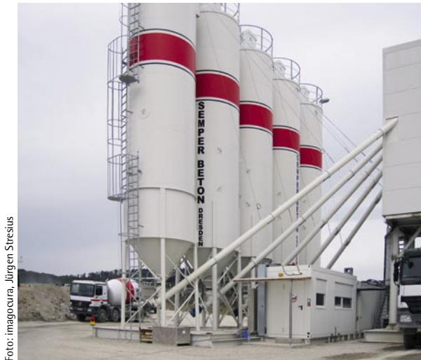
Bild 11: Baustellenanlage zur Bereitstellung des Betons
